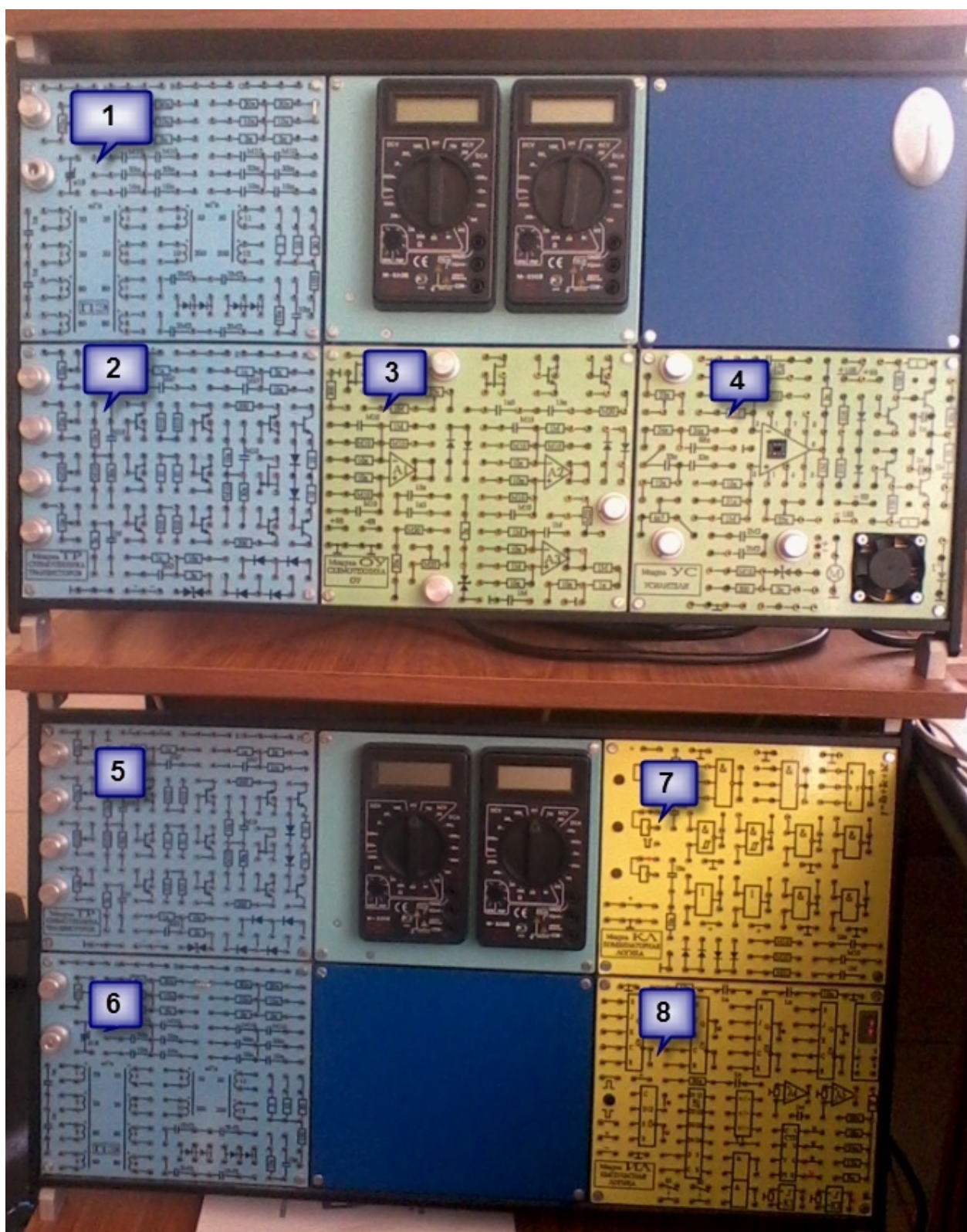
Рис.1(В) - 1,6-пассивные элементы (ПЭ), 2,5-транзисторы (ТР), 3-операционные усилители (ОУ), 4-усилители (УС), 7-комбинаторная логика(КЛ), 8- импульсная логика (ИЛ)
